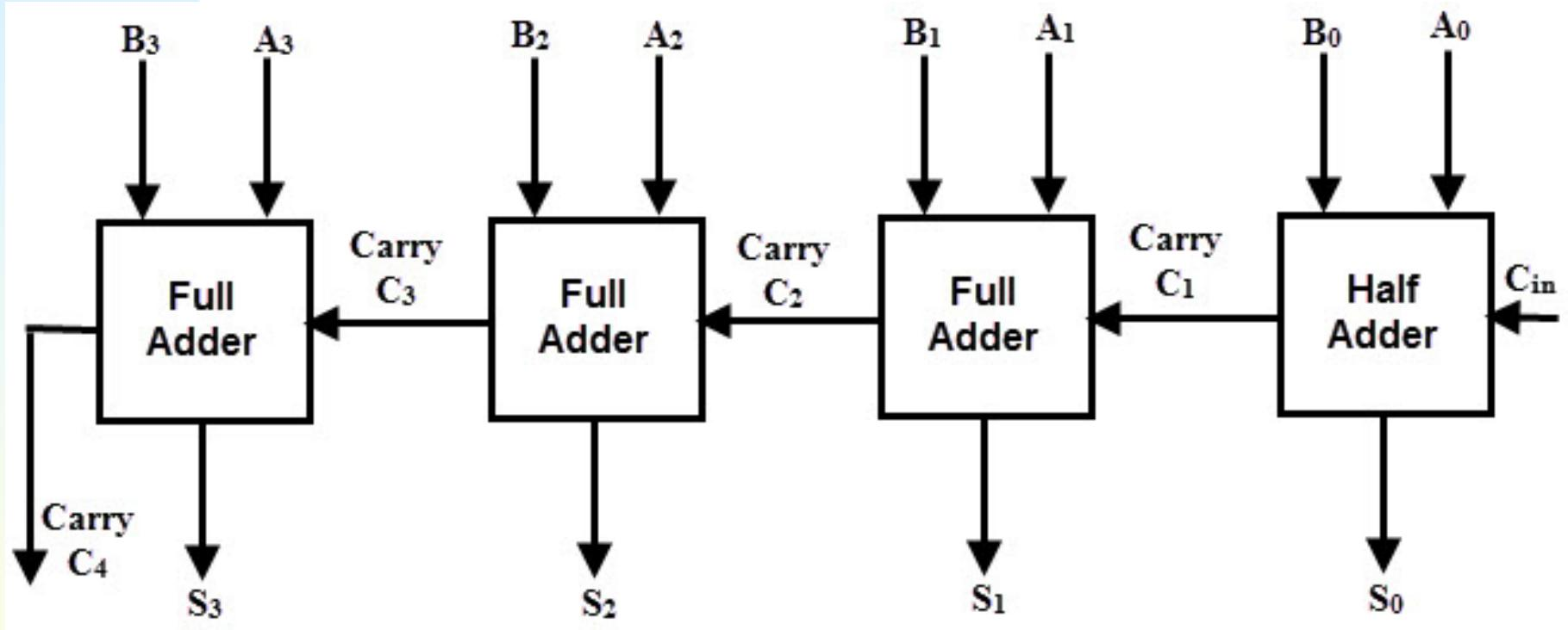
$$A(3 : 0) + B(3 : 0) + C_{in} = S(3 : 0) + C_{out}$$
