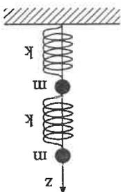
5. Betrakta ett system med två massor med massan  $m$  och två fjädrar med fjäderkonstanten  $k$  och den naturliga längden  $a$  enligt figur. Massorna kan röra sig vertikalt längs med  $z$ -axeln och påverkas således av både krafterna från fjädrarna och gravitationskraften. Bestäm systemets vinkelrekvenser.
