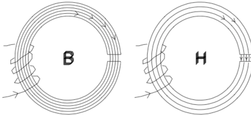
Figur 1: B - och H -fältlinjer i en toroidspole med luftgap
